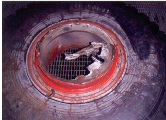
شکل ۱: چرخ شکسته حرکت‌دهنده ترومل شستشوی اولیه چغندر
